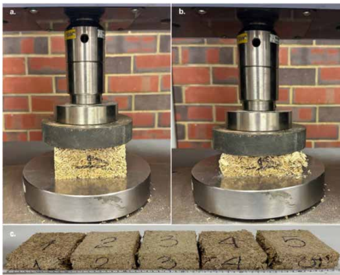
Рис. 1. Міцність на стиск зразків ізоляційних матеріалів на основі конопель: (а) до випробувань, (б) під стиском та (с) після дії навантаження 49 \pm 1 кН
